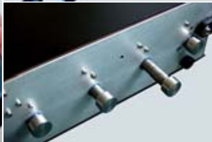
01 | Zvukoměr 02 | Zdroj kročejového zvuku 03 | Detail zdroje kročejového zvuku
